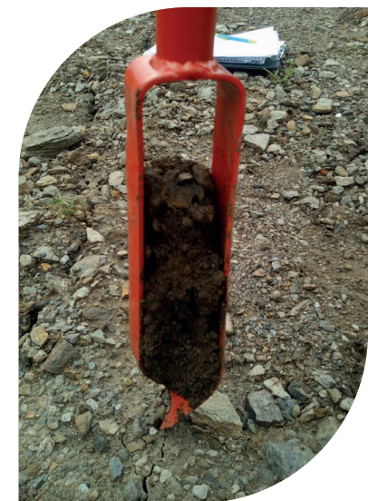
Prélèvement de terre à la tarière
